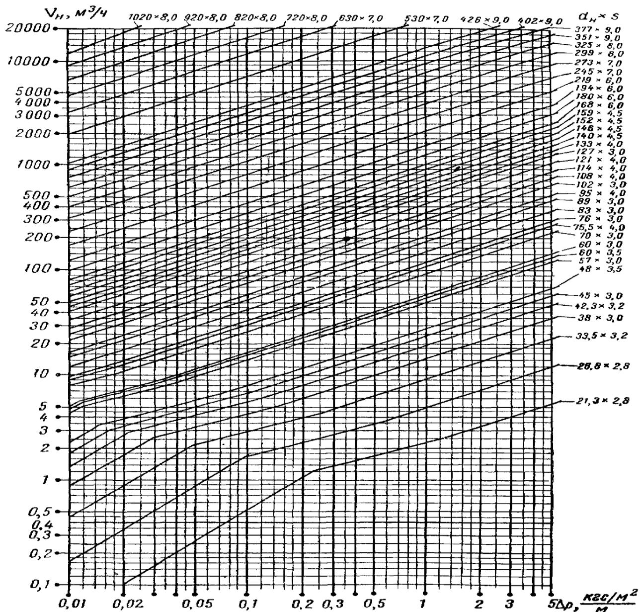
Рис.: Номограмма для определения удельных потерь давления в газопроводах низкого давления (природный газ,  $\rho = 0,73 \text{ кг}/\text{м}^3$ ,  $v = 14,3 \times 10^{-6} \text{ м}^2/\text{сек}$ ).
